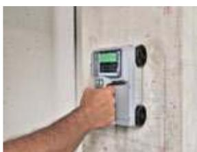
I radar convenzionali possono rilevare bersagli a distanza di molto chilometri, mentre il radar per strutture opera generalmente a distanze massime di un metro; La risoluzione dei radar convenzionali è dell'ordine delle decine di metri, mentre il radar per strutture può avere risoluzioni dell'ordine dei centimetri.
