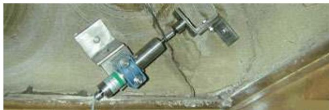
Oltre ai semplici fessurimetri sopra descritti si possono collocare sulle fratture una serie di sclerometri fessurimetri dove viene misurata la stensione dello spostamento.
